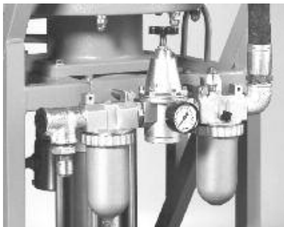
Durch die serienmäßig integrierte Wartungseinheit wird Vereisen weitgehend verhindert.
